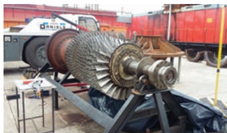
▲ Personal preparando el izaje del rotor para su posterior limpieza, balanceo y ensayos no destructivos.
