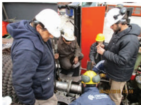
▲ Personal preparando el izaje del rotor para su posterior limpieza, balanceo y ensayos no destructivos.
