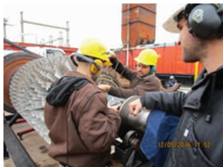
▲ Tareas de ensayo de ultrasonido con asistencia de personal de la Central 9 de Julio.
